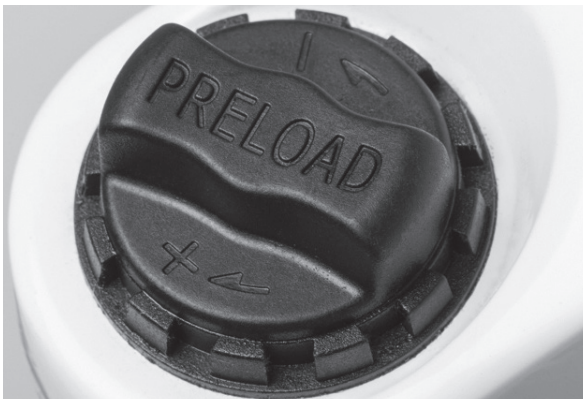
Abbildung 53: Einstellrad SAG auf der Krone der Federgabel
